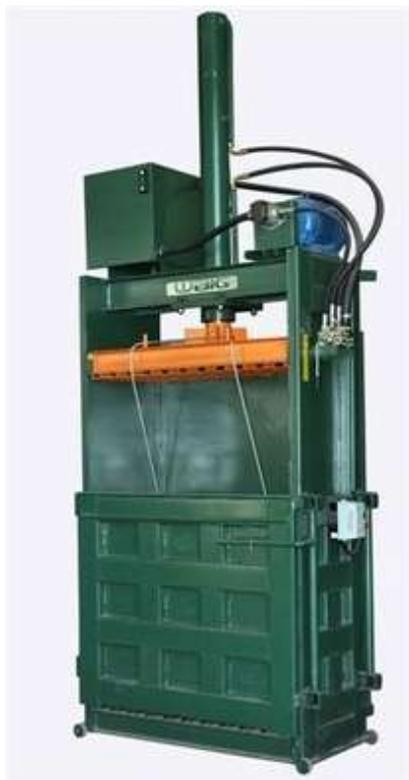
Figura 20 – Prensa Utilizada na Prensagem e Compactação dos Resíduos.
